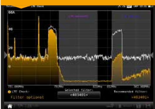
Analiza la influencia de la señal LTE sobre canales TDT, detectando la necesidad de incorporar o no filtros. Además permite simular el espectro tras haber incorporado un filtro LTE que el propio medidor recomienda. Se presenta un listado de filtros para que el usuario pueda elegir el que más se ajuste a su instalación.
