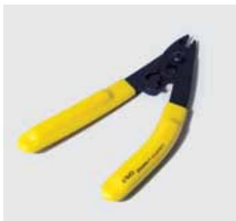
Herramienta que se utiliza para obtener la fibra en su tramo de 125mm (cladding) previo a su fusión. Permite retirar la funda plástica de la fibra así como la protección de acrilato de 250mm.
