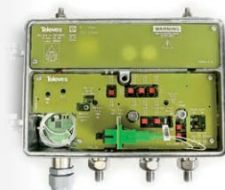
▲ Приемник оптический наружный (232 x 140 x 90 мм)
