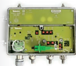
▲ Приемник оптический наружный (232 x 140 x 90 мм)
