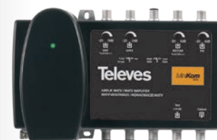
▲ Усилитель: Серия MiniKom "F" (185 x 112 x 70 мм)
