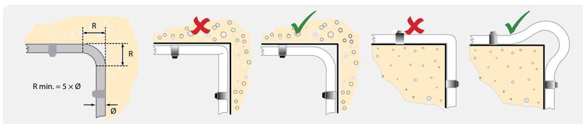
Le câble coaxial doit toujours être fixé.
