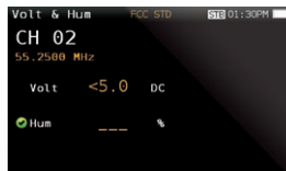
VOLTÍMETRO Y HUM TENSIÓN Y RUIDO DE ALIMENTACIÓN PRESENTE EN LA RED DE CABLE.
