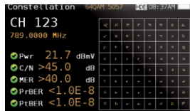
PANTALLA CONSTELACIÓN ANALIZA EN DETALLE LA SEÑAL QAM
