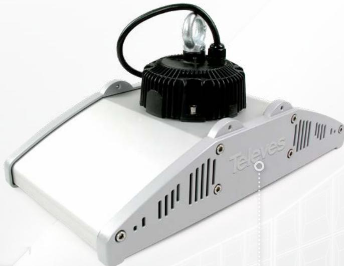
Högpresterande, högkvalitativ LED-armatur för inomhusbruk. Tillverkad av extruderad och anodiserad aluminium som ökar dess motståndskraft mot slag och korrosion, vilket garanterar hög hållbarhet.
