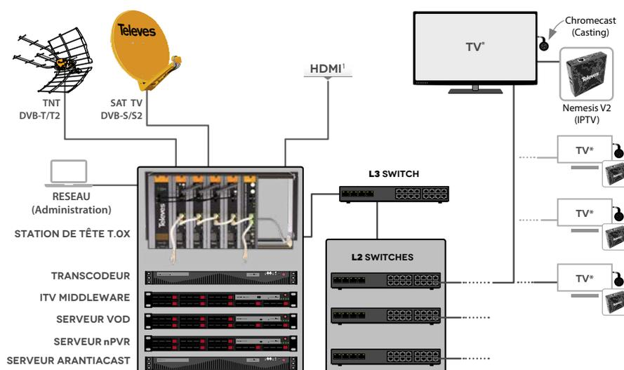
Ce schéma montre les différentes parties de l'architecture du système :
