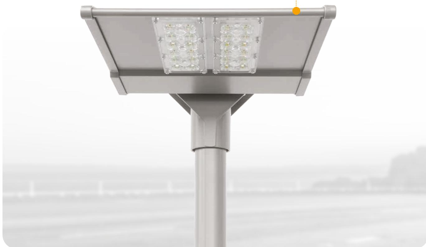
Apparecchio per l'illuminazione a LED stradale altamente versatile adattabile a qualsiasi ambiente esterno, costruito in alluminio estruso anodizzato progettato per una perfetta gestione termica, durata nel tempo ottimizzata e resistenza in ambienti ostili.
