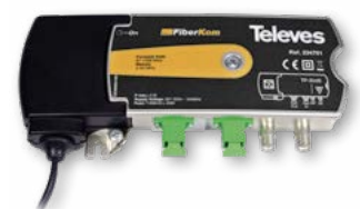
▲ Mini-Nodi: Serie FiberKom 185 x 80 x 35 mm
