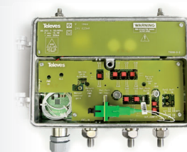
▲ Nœud d'extérieur : (232 x 140 x 90 mm)
