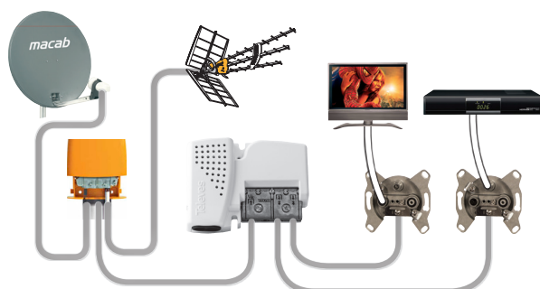
Exempel på inkoppling med mastförstärkare och inomhusförstärkare.
