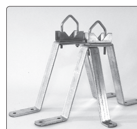
Art.nr: 522 21 02 Väggfäste VF-230P, 23 cm från vägg, för rör 30-50 mm. E-nr: 60 611 41
