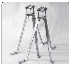
Art.nr: 522 21 04 Väggfäste VF-500P, 50 cm från vägg, för rör 50-76 mm. E-nr: 60 611 46
