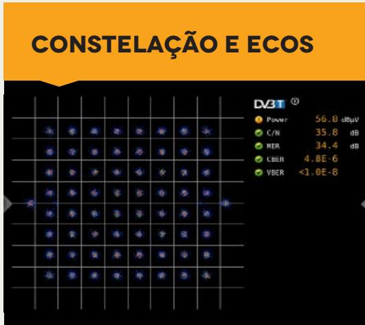
Duas funções fundamentais para assegurar uma correcta recepção do sinal. O diagrama de constelação é indispensável para ajudar a detectar a presença de ruído, jitter de fase, interferências e outros problemas que podem afectar a qualidade do sinal reduzindo a MER. A representação gráfica dos ecos permite identificar a presença dos mesmos na recepção do sinal terrestre DVB-T/T2, que pode degradar consideravelmente a medida BER.
