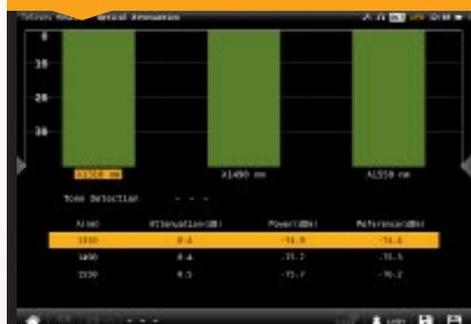
Uma vez activada a entrada de fibra óptica o receptor óptico (selectivo ou não) possibilita medir a atenuação óptica em três comprimentos de onda (1310nm, 1490nm e 1550nm) e respectivas potências, permite analisar também instalações RFOG.
