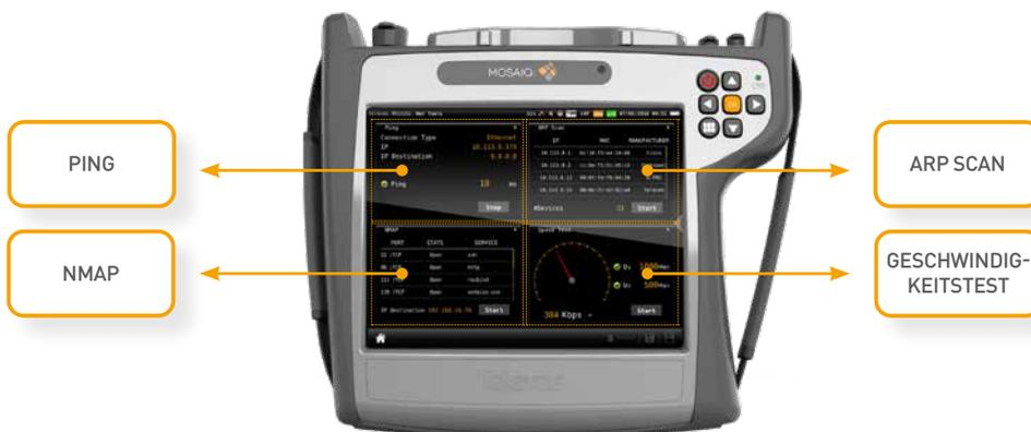
Diese Funktionalität bietet mehrere Steuerungsprogramme und Netzwerküberwachungsoptionen, die im Mosaikmodus angezeigt werden können. Alle Netzwerkinformationen gleichzeitig auf einem einzigen Bildschirm (IP, DNS, Gateway, Verbindungsmodus...).
