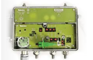
▲ Węzeł Optyczny Zewnętrzny: (232 x 140 x 90 mm)
