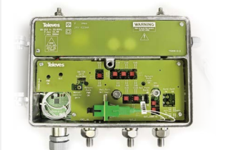
▲ Odbiornik Optyczny Zewnętrzny (232 x 140 x 90 mm)
