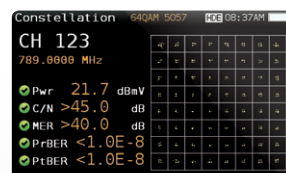
PANTALLA CONSTELACIÓN ANALIZA EN DETALLE LA SEÑAL QAM
