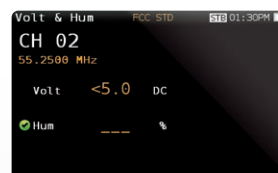
VOLTÍMETRO Y HUM TENSIÓN Y RUIDO DE ALIMENTACIÓN PRESENTE EN LA RED DE CABLE.
