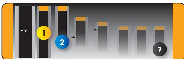
Dans le cas où il y aurait plus de 7 modules T.OX utilisés, prévoir plus d'un module pour l'alimentation. Pour les combinaisons d'amplificateurs monocanaux avec les modules T.OX, nous consulter.
