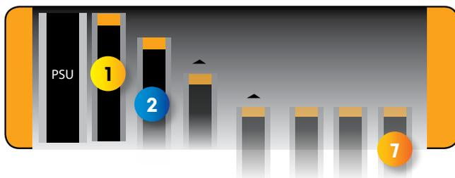
Dans le cas où il y aurait plus de 7 modules T.OX utilisés, prévoir plus d'un module pour l'alimentation.
