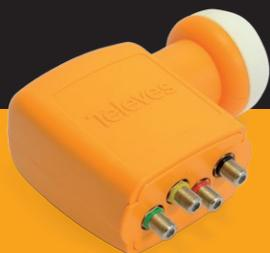
Un conversor LNB, comúnmente llamado LNB (*Low Noise Block Down Converter*) es el elemento que debemos instalar en el brazo de la parabólica y es el encargado de recibir las altas frecuencias emitidas por el satélite (del orden de GHz) para moverlas a bajas frecuencias de TV (MHz) que es como llegan a los receptores.
