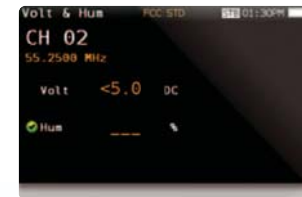
VOLTMÈTRE ET HUM TENSION ET BRUIT D'ALIMENTATION PRÉSENT DANS LE RÉSEAU CÂBLE.
