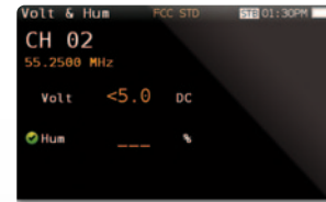
VOLTÍMETRO E HUM TENSÃO E RUIDO DE ALIMENTAÇÃO PRESENTE NA REDE DE CABO
