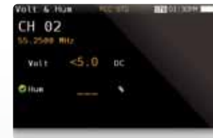
ВОЛЬТМЕТР И HUM ИЗМЕРЕНИЕ НАПЯЖЕНИЯ И ШУМА СЕТИ 220 В В КАБЕЛЬНОЙ СЕТИ
