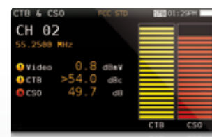
CSO & CTB ДЕТАЛЬНОЕ ОПИСАНИЕ ПАРАМЕТРОВ АНАЛОГОВОГО СИГНАЛА
