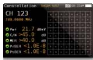
ДИАГРАМА СОЗВЕЗДИЯ ПОДРОБНЫЙ АНАЛИЗ СИГНАЛА QAM
