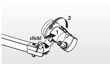
Во время установки для фиксации LNB конвертора вставьте его в держатель.
