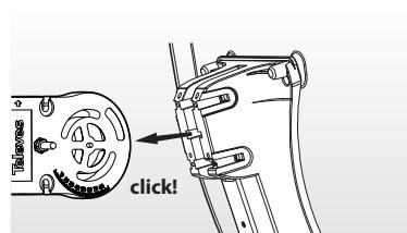
Опора рефлектора легко монтируется в подъемный механизм.
