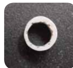
Рис.2 подробная асимметрия покрытия обнаруживается в испытательном центре
