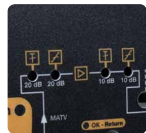
Blockschaltbild auf dem Verstärker für einfache Einstellung.
