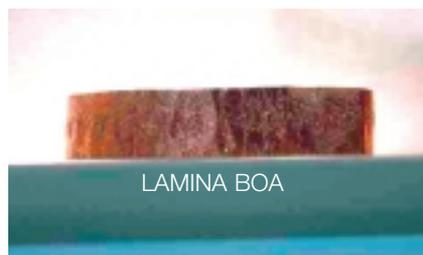
A lâmina do cabo Televés T100, Ref 2141, continuou com as características originais e a lâmina de um cabo Não Televés quebrou em vários pontos da curva e, por consequência, deixou de cumprir as suas funções.
