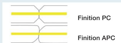
Par exemple, une liaison apparemment correcte équipée d'un connecteur SC/PC mâle et d'un connecteur SC/APC femelle, va complètement dégrader le signal.
