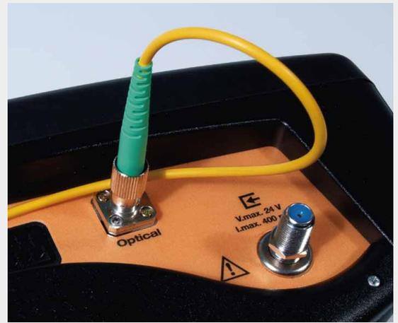
Il est évident que ce serait une mesure approximative et insuffisante car l'émetteur travaille dans une seule plage (1310nm) alors que la mesure doit être effectuée sur les trois plages de fréquences.
