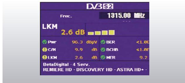
Cependant, la qualité des signaux TVSAT ne dépend pas tant du facteur de bruit du LNB que du C/N total obtenu. En fait, dans le contexte des émissions actuelles en DVB-S2 et HDTV, le bruit de phase est un paramètre encore plus restrictif que le facteur de bruit.
