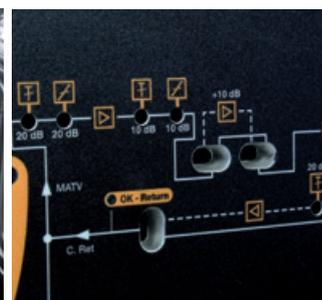
Diagramme bloc de l'amplificateur en façade du boîtier.
