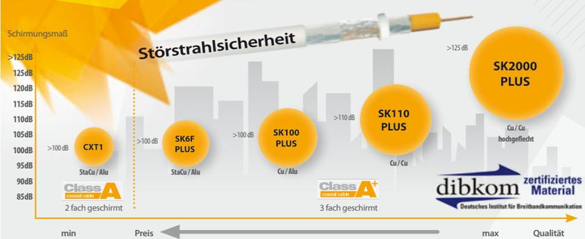
Televes präsentiert mit SK100PLUS und SK110PLUS zwei neue Breitband-Koaxialkabel, die die Anforderungen der Schirmungsklasse A+ (EN 50117) deutlich übertreffen. Dadurch sind sie für alle Multimediaanwendungen geeignet, beispielsweise in rückkanalfähigen BK-Netzen, bei der Sat-ZF-Verteilung oder in Gemeinschaftsempfangsanlagen.
