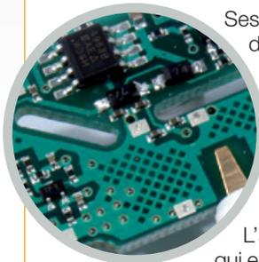
Ses dimensions viennent de l'utilisation de la dernière génération de microcomposants, que seule une technologie de production comme celle de Televés est capable de mettre en place avec une fiabilité totale grâce à l'utilisation de lignes robotisées pour la manipulation de ces microcomposants.
