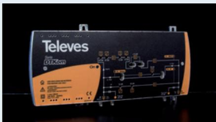
In generale la massima tensione di uscita riportata nelle caratteristiche di un amplificatore segue lo standard DIN45004B EN 50083 che indica il livello massimo di uscita quando in ingresso abbiamo 2 canali analogici con ampiezza uguale.
