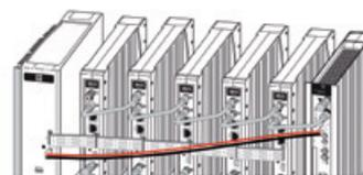
Alimenté en 24 Vdc par le module alimentation
