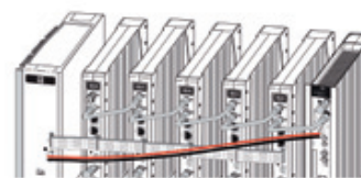
Zasilanie z 24 VDC od PSU
