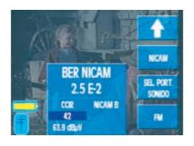
Repartidores, Tomadas, ....), reflexões, etc. Para se diagnosticar a possível origem da ausência do Stereo NICAM num determinado televisor da instalação, nada é mais aconselhável do que medir o BER deste tipo de modulação agora disponível na opção 5912.
