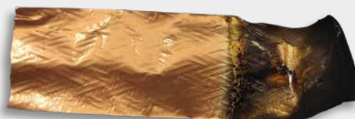
Lâmina sem cobre (com pigmento), depois de se queimar
