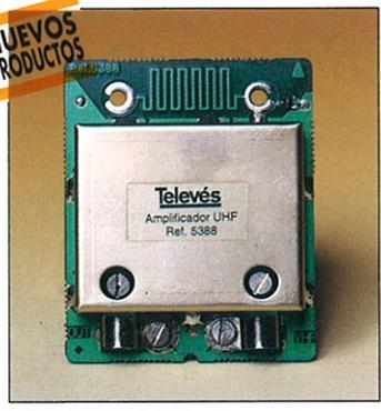
Cabe también destacar la incorporación de tecnología microstrip y líneas impresas, que evita cualquier desajuste en el circuito, así como el excelente blindaje de las tapas metálicas que lo protegen, que elimina las radiaciones de señal y la interferencia de señales parásitas ■
