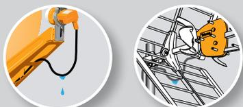
Détails des courbes de câble en sortie d'antenne
