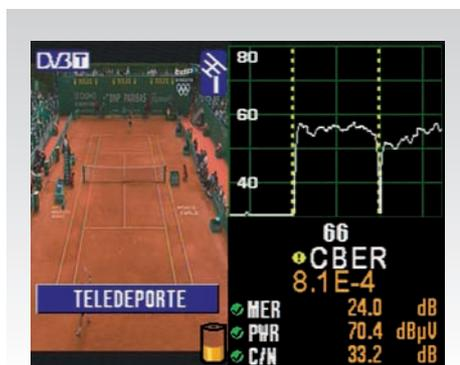
Todo ello en una misma pantalla: espectro, imagen, medidas, procesado de las medidas e indicación gráfica de la calidad de la señal. Máxima facilidad de uso y máxima precisión en las medidas en un mínimo tiempo empleado en la instalación.
