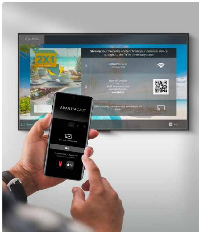
profissional ligado ao televisor por HDMI e é **compatível com a grande parte das televisões, sem necessidade de ser Smart TV, nem específicas para Hotelaria**. A segunda é a integração direta de uma licença nas televisões que o permitam (modelos Philips e LG com tecnologia Google Cast). Em ambos os casos, exige-se a instalação do servidor ArantiaCast na cabeça de rede, que será responsável pela gestão global do sistema ■
