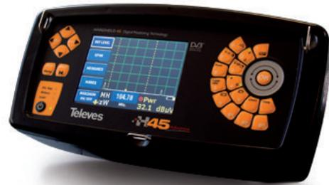
El rango dinámico de estos medidores, permite realizar lecturas de C/N (fig.2).
