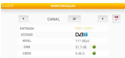
Embora esta função seja muito útil para uma comprovação rápida, **deve ser sempre complementada com um medidor de campo profissional** para garantir uma certificação exata da instalação.
