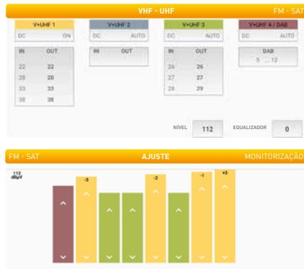
Adicionalmente, deslizando os ecrãs para a esquerda, na opção de "AJUSTE" é possível realizar um ajuste fino de cada canal e mudar ligeiramente os níveis de amplificação com uma diferença de até 3 dB. Se forem realizados ajustes, será necessário voltar a enviar a configuração à central.
