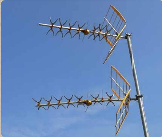
Desconocemos si la intención era la de incrementar la relación D/A de la antena, o aprovechar la señal reflejada en el propio reflector y así reforzar la señal captada por el dipolo. No sabemos si mantener los elementos directores plegados (como se sirven de fábrica) tiene relación con el tipo de polaridad recibida (H/V). Obviamente el montaje es un alarde de imaginación, carente de prestaciones.
