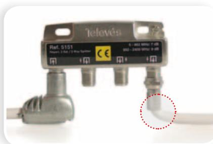
En situaciones donde el cable debe realizar trazados con radios inferiores al mínimo, la utilización de conectores blindados acodados es la solución. En la imagen se aprecia **cómo un conector Easy F preserva la integridad del cable frente a un conector F recto.**
