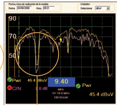
Señal Coaxdata. Se observa el "Gap" que el Coaxdata inserta para no afectar a la señal de AM.
