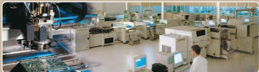
El uso en Televisión de componentes de montaje superficial (SMD) se remonta al principio de los años 80. La MS72 de Siemens colocaba hasta 2.200 componentes a la hora en el año 1983.
