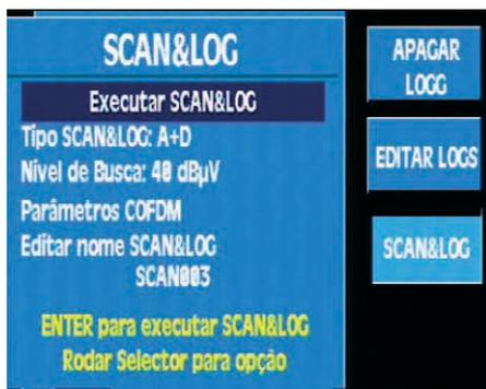
**Analógico + Digital:** identificará tanto os canais analógicos como os digitais COFDM e fará as medidas segundo corresponda. Se se tratar de um canal analógico medirá nível, C/N e V/A. Se
