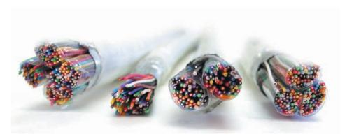
Estes são TVHV porque se compõem de: Condutor em cobre macio de 0,5mm (24 AWG) - TV; Blindagem em lâmina de alumínio e poliéster - H; Cobertura exterior em PVC - V.
